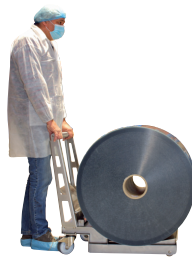
Faire rouler la bobine sur le chariot.
