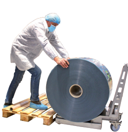
Placer le chariot contre la palette, bloquer les roues.
